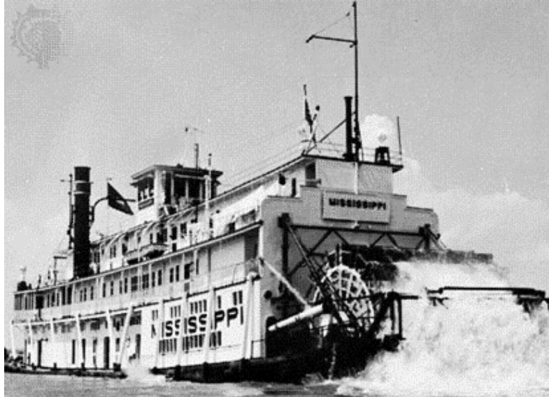
Figuur 21: Mississippi stoomboot met schepraderen (uit Britannica Encyclopedia)
